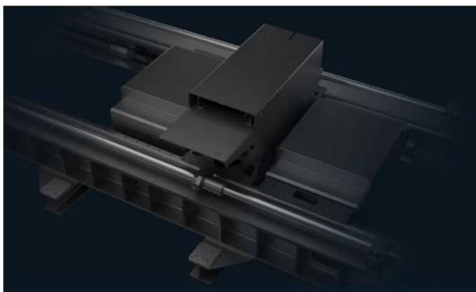
2-сурет - Single Pass Jetting технологиясының жұмыс жасау құрылысы.
